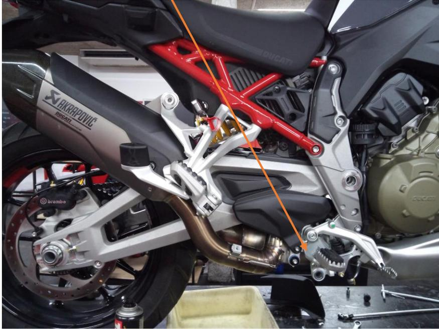
2. Respetar el par de apriete de este tornillo, no es el eje del basculante, solo actúa como soporte del embellecedor de chasis
