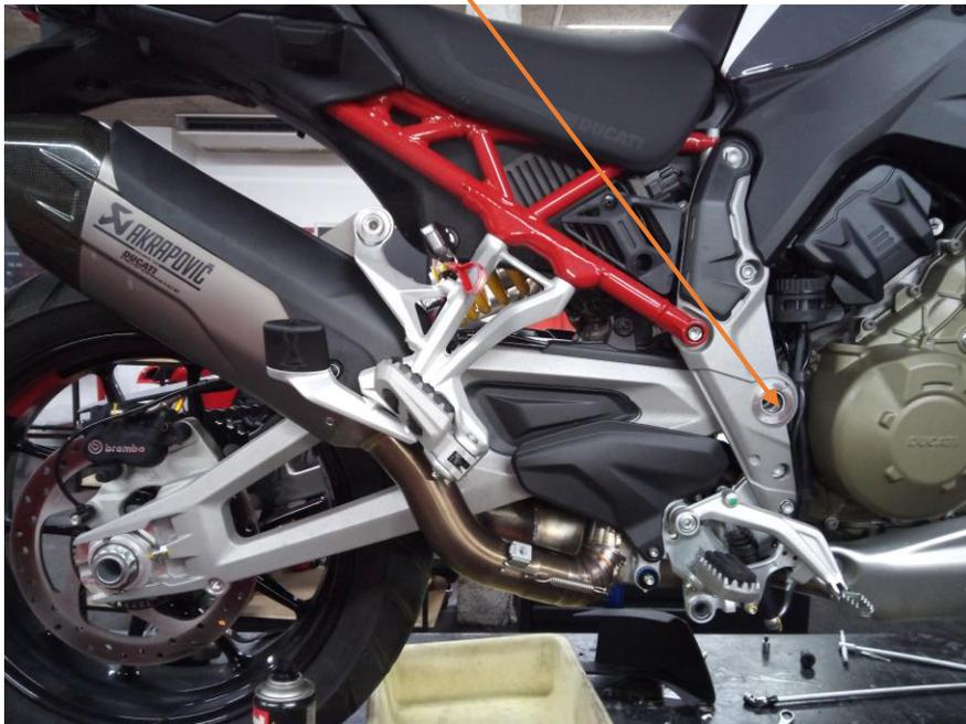
3. El silentblock izquierdo del catalizador original NO SE UTILIZA, solo se utiliza el silentblock derecho.
